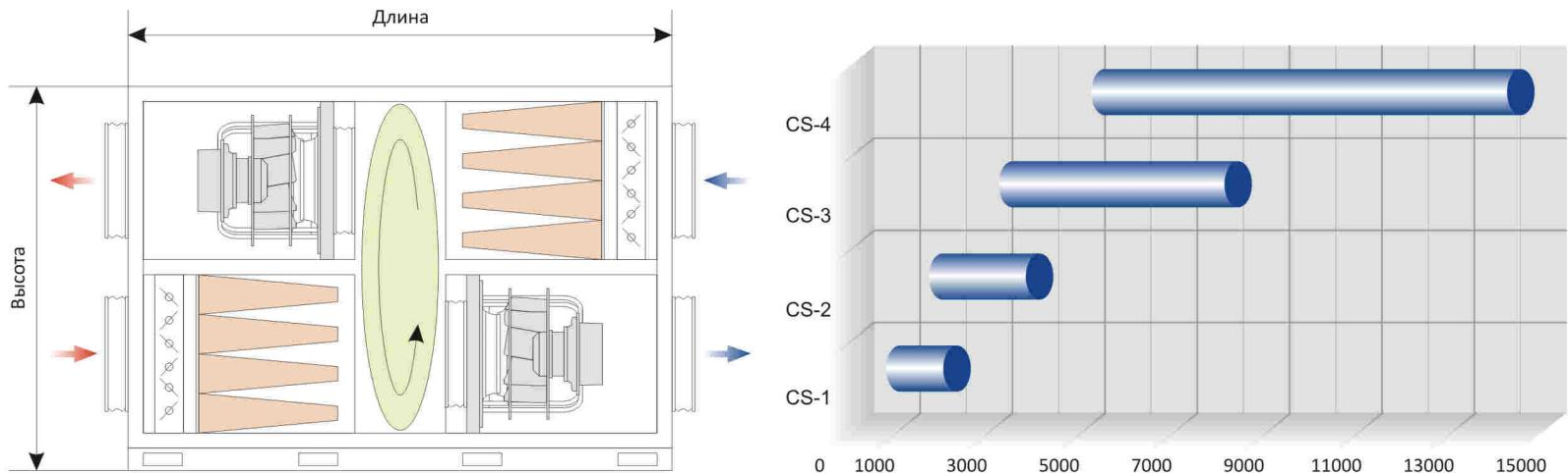
Вентиляционные установки CrossStar состоят из трех частей для транспортировки через ограниченные проемы.
